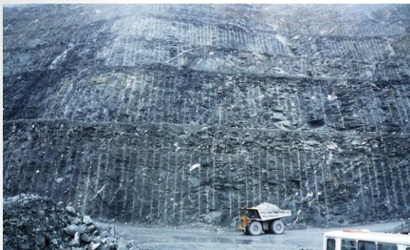
оптимизация параметров буровзрывных работ вблизи предельного контура
