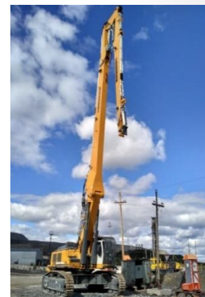
оборка заколов на уступах с применением специальной техники
